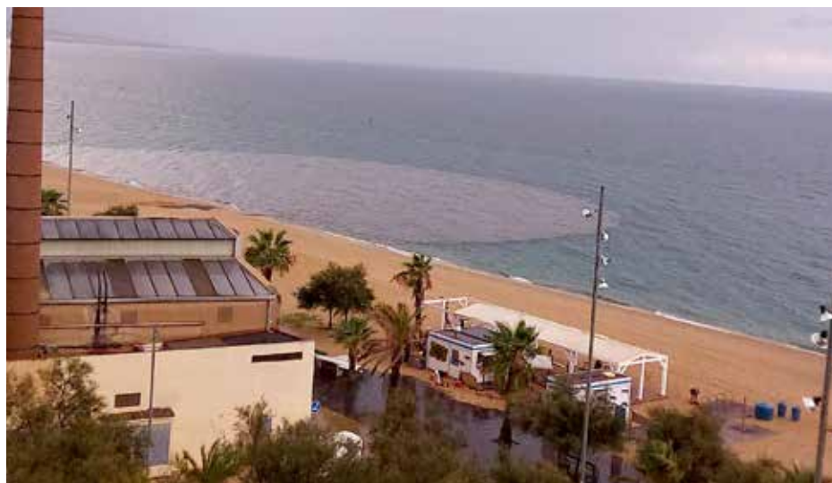
La platja de Badalona després d'un abocament d'aigües residuals no tractades per la saturació del clavegueram unitari en episodis de pluja. Font: Badalona Mar.
