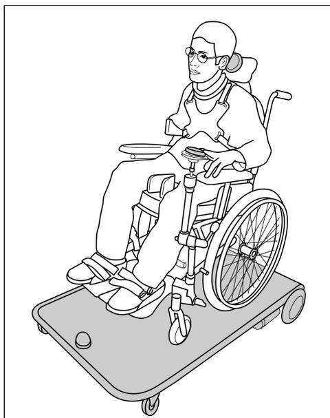
**Figura 9.1 Pedro en su silla autopropropulsada, situada en la plataforma para el desplazamiento que activa con un pulsador situado en la parte posterior de la cabeza para avanzar y con un pulsador para girar al alcance de la mano izquierda.**
