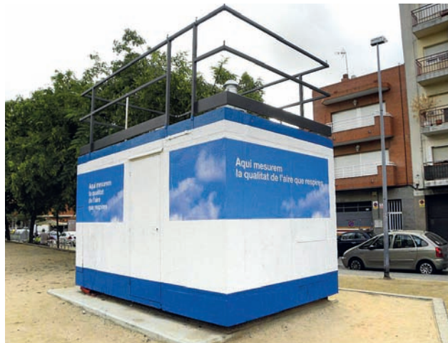
Cabina de mesura de qualitat de l'aire.
